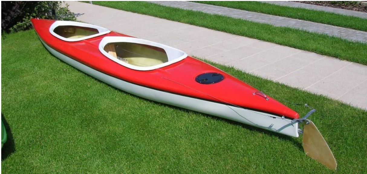
43. kép: Kétszemélyes üvegszövetes túrakajak
