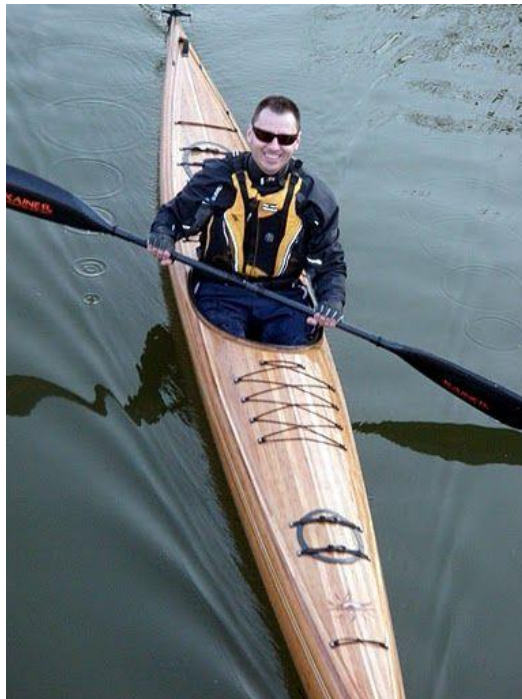
42. kép: Mézes Pál égerfából készített kajakja.
